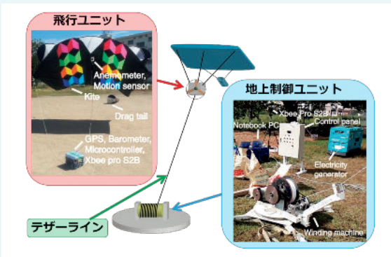
高空風力発電ロボットの仕組み
