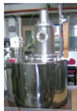
電磁波発生装置「ジャイロトロン」
